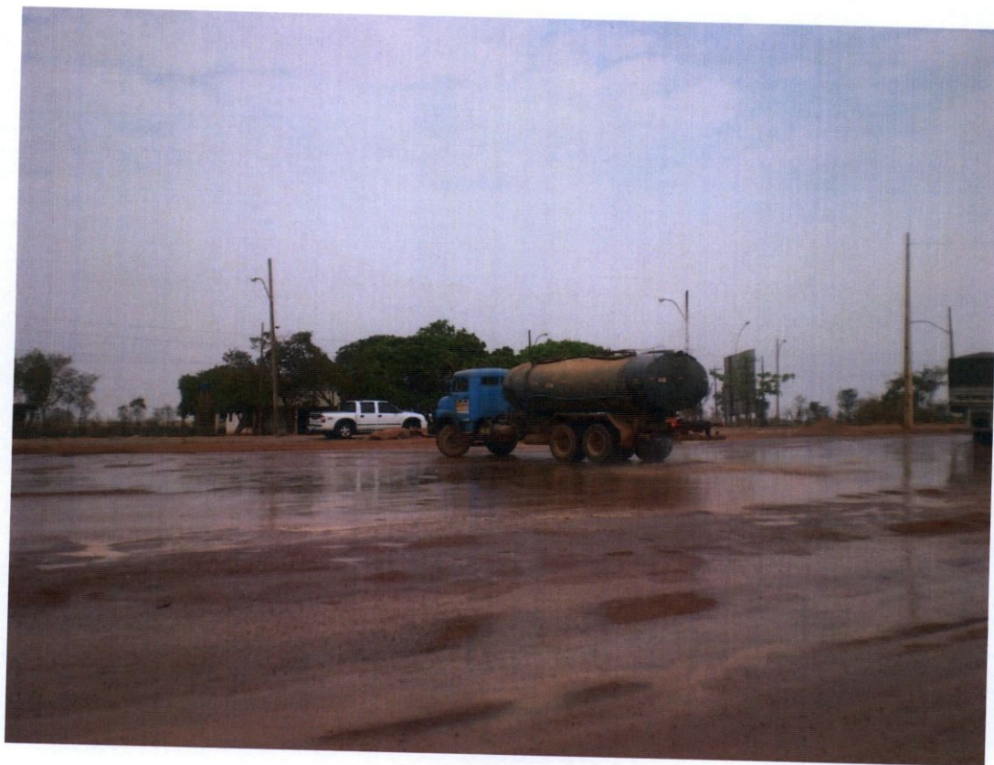
Foto 8 e 9- Caminhão pipa molhando o pátio do Posto Fiscalização do Talismã tentando apagar a poeira gerada pelo excesso de buracos no pavimento.
